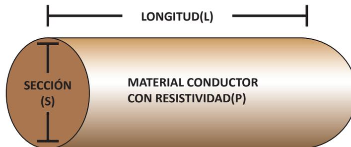
**Resistividad:** Se define como la resistencia de un conductor de 1 m de longitud y 1 m<sup>2</sup> de sección a 0° C. Es una característica propia de cada elemento o material y es importante para saber qué materiales nos ofrecerán mayor o menor resistencia al paso de la corriente. El símbolo es la letra griega Rho " $\rho$ ". La unidad de resistividad es  $\Omega \times \text{mm}^2 / \text{m}$
