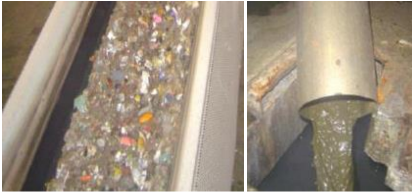
Figura 32: Ejemplo de sustrato conforme a condiciones de pretratamiento con operación vía húmeda.
