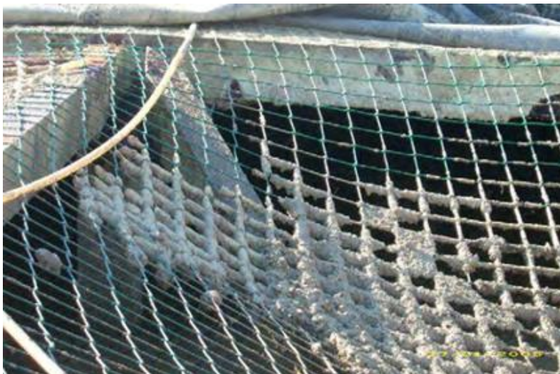
Figura 57: Precipitación de azufre en la malla utilizada para sustentar los microorganismos sulfo-oxidantes.
