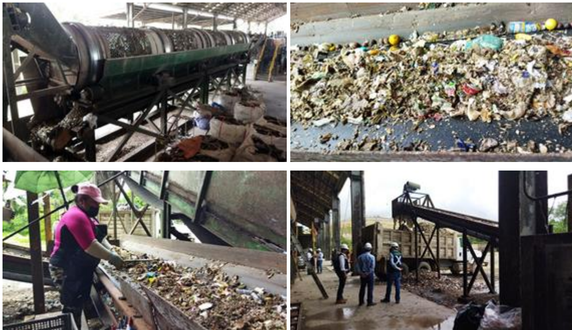
Figura 5: Flujo de la Fracción Orgánica de Residuos en la Planta de Tratamiento.
