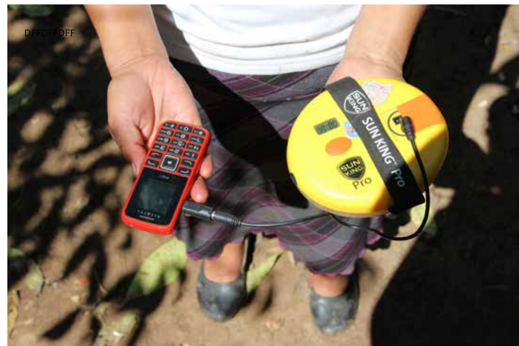
Un sistema pico fotovoltaico utilizado para la recarga de un celular.
