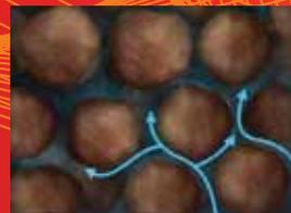
**PERMEABILIDADE:** uma medida da capacidade dos espaços porosos se conectarem por canais, permitindo o fluxo de hidrocarbonetos.
