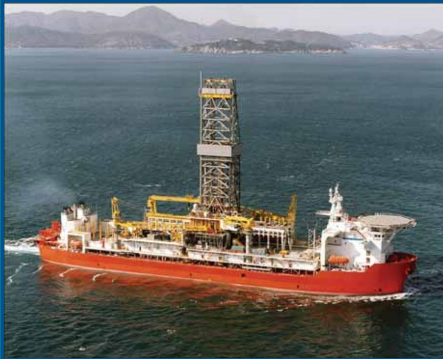
*Os navios sonda dispõem de tecnologia de posicionamento dinâmico com acesso contínuo aos satélites de posicionamento global para mantê-los no local exacto.*
