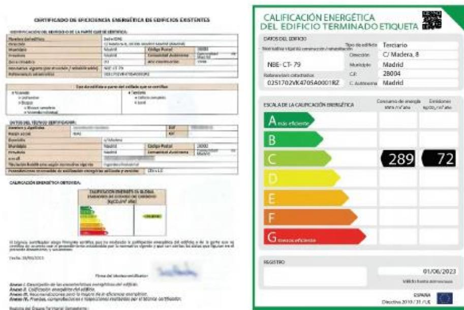
**Figura 3: Certificado de desempeño energético – portada y etiqueta de eficiencia energética**
