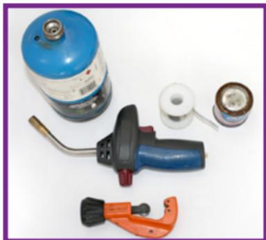
Fotografía 30. Tanque de gas, cortador de tubo de cobre, soldadura, pasta y soplete.
