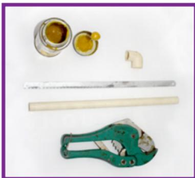
Fotografía 32. Pegamento CPVC, Segueta, cortador de tubo y material CPVC.
