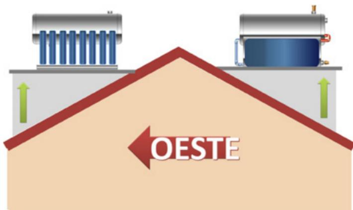
Figura 39. Instalación de CSA en techos con inclinación ESTE/OESTE.
