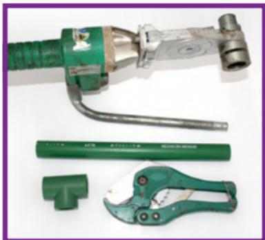
Fotografía 31. Cortador de tubo polímero termosoldable, termofusionador y material.
