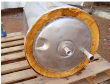
Fotografía 6. Corte transversal de un termotanque.
