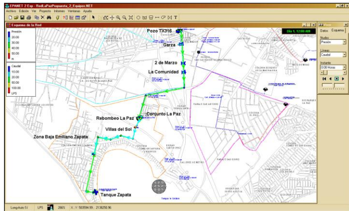
Figura 4-128. Imagen de la modelación hidráulica realizada para el análisis de alternativas de mejora
