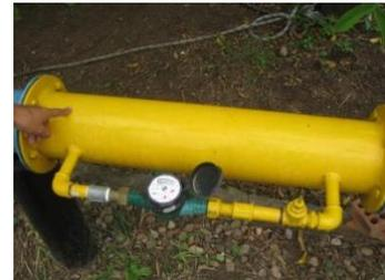
قياس تدفق المياه لمصدر مياه باستخدام عداد مياه متناسب ذو تكلفة منخفضة
