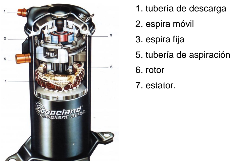
Figura 22 Compresor Scroll
