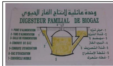
Photo 5: Digesteur expérimental développé et réalisé par le centre de Sidi Thabet
