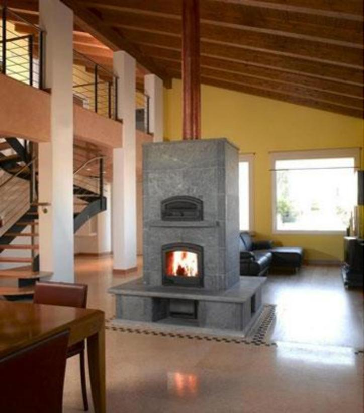
Les poêles de masse finlandais ont la particularité d'être réalisés en stéatite, une pierre volcanique dont la capacité d'accumulation et la durée de restitution de chaleur sont intéressantes.
