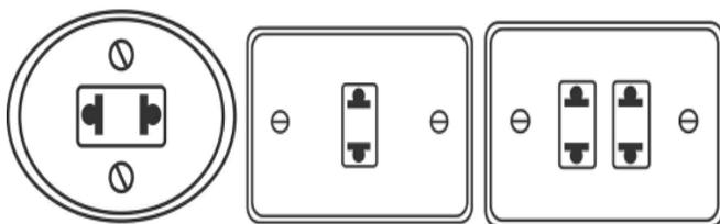
*En domicilios que utilizan sistemas fotovoltaicos pequeños —de hasta 80 Wp y que no poseen inversor— se deben instalar tomacorrientes polarizados de 12 V.*
