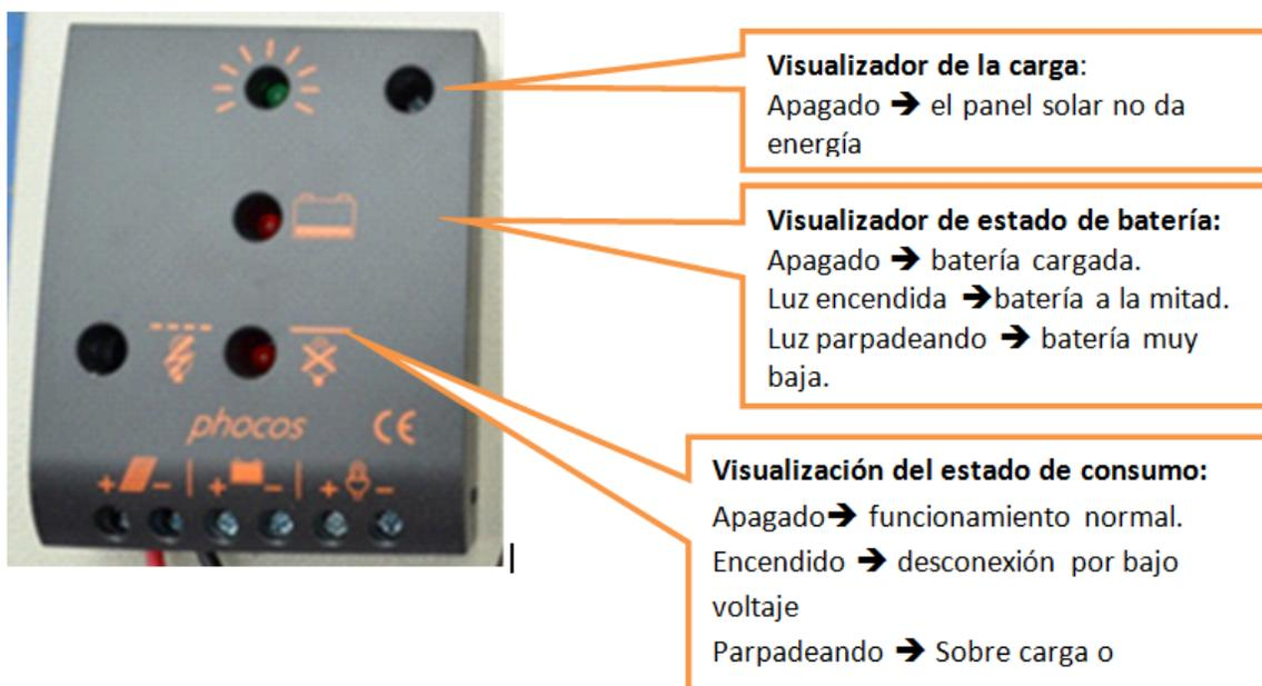
El funcionamiento del panel se puede revisar desde el regulador, para ello utilice el multímetro colocando las puntas correspondientes en la conexión que tiene el regulador de carga con los cables provenientes del panel solar.
