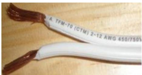
**Cable mellizo**, son apropiados para instalaciones en áreas no peligrosas, como conductores para los aparatos domésticos fijos, lámpara colgante o fija. Por lo general, se usan en instalaciones eléctricas visibles, en lugares secos. El calibre no debe ser inferior al N° 16 AWG.
