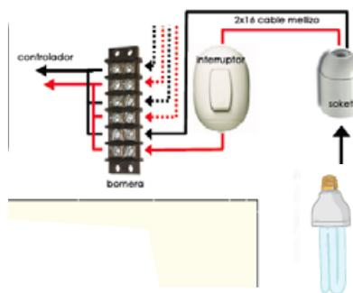
**Recuerde**, los sistemas fotovoltaicos normalmente utilizaran cargas en corriente continua al tener un panel de poca potencia (< 100 Wp). En el caso del sistema fotovoltaico estudiado en el curso, se utilizaran los focos ahorradores o CFL.
