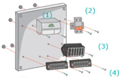
*Acorde al modelo de sistema fotovoltaico que se instale, en algunos casos el tablero de control puede contener el inversor, el convertidor, la caja de portafusibles, los adaptadores tipo encendedor, borneras de baquelita y la llave termomagnética.*
