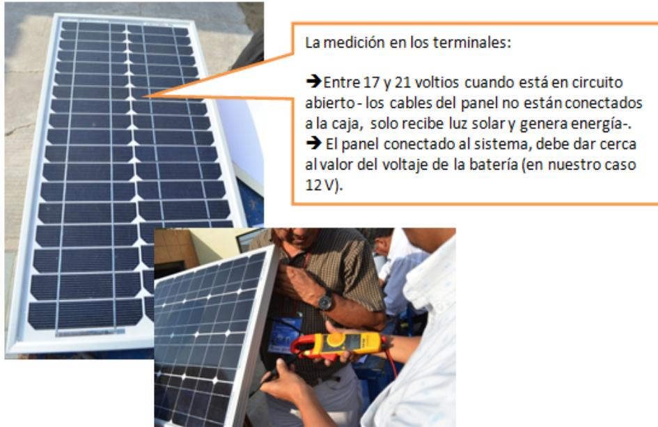
*Si hay problemas de carga en el sistema fotovoltaico, se debe medir la generación de amperaje o corriente del panel (hacer uso del multitester o pinza amperimétrica).*
