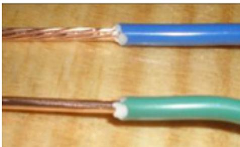
**Alambre o cable TW**, se usa en instalaciones fijas, edificaciones, interior de locales con ambientes secos o húmedos.
