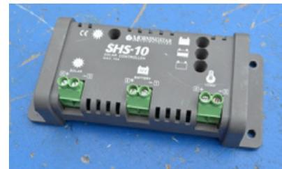
*El regulador contribuye a disminuir la descarga de la batería para que no se dañe. Mantiene el nivel de carga normalmente no menor al 40% de su capacidad de carga.*
