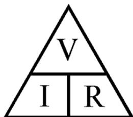
La ley de Ohm nos da la relación que existe entre el Voltaje (V), la Intensidad de Corriente (I) y la Resistencia (R) de la siguiente manera:
