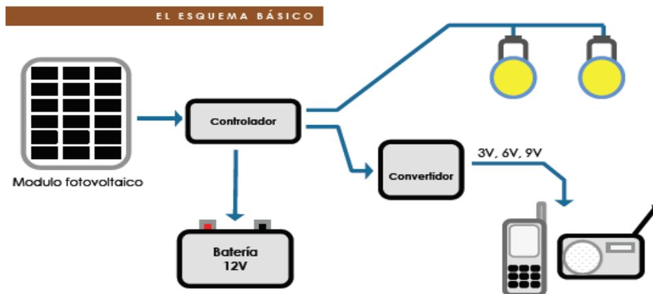
Sin embargo, es necesario aclarar que dependiendo de la configuración del Sistema Fotovoltaico, estos pueden variar en relación a los componentes que son incorporados, por ejemplo en algunos se incluyen el inversor y el convertidor de corriente; o las especificaciones de cómo instalarlo – en cajas de metal, tablas de madera, soporte de metal, poste, techo, etc..
