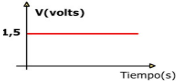
*Corriente Continua (CC)*, es cuando el voltaje y polaridad se mantiene constante, es decir positivo y negativo no cambian. Por ejemplo las pilas y baterías.
