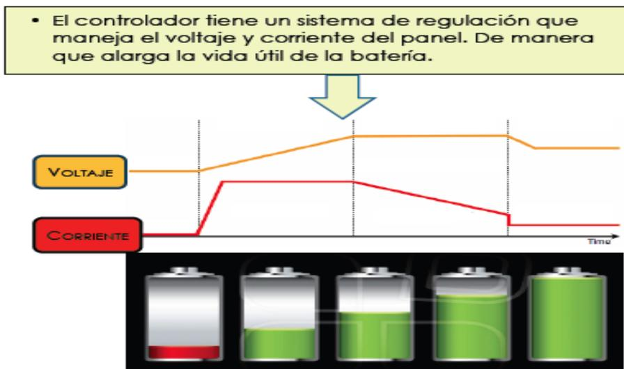
Factores inconstantes como la radiación solar y la temperatura ambiental influyen directamente el amperaje y voltaje producidos por el panel solar. El controlador de carga regula los niveles de estas variables según el estado de carga de la batería.
