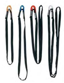
Anclajes Temporales, (Cintas y Anillos de Cinta), este material es fabricado generalmente de poliamida y polietileno, las encontramos también metálicas, siendo las primeras las más cómodas y ligeras para su transporte. Su función es conectar la línea de anclaje a una estructura para poder trabajar, las encontramos abiertas o en forma de anillos cocidos, en cualquier caso, deben tener una resistencia mínima de 22 KN.
