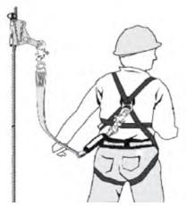
Líneas de Vida Verticales Flexibles, (EN 353-2), este tipo de líneas de vida pueden ser de cuerda o de cables, estos últimos podrán tener un sistema de disipación o absorción de energía, sobre su anclaje superior, de lo contrario cada usuario contara con un absorbedor de energía en el caso de ser de cable, en las de cuerda no es habitual su uso, (absorbedores de energía), ya que las mismas tienen propiedades de elongación que amortiguan la caída.
