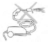
Se debe evitar los chorros de alta presión tipo "Karcher" ya que un chorro de alta presión puede retirar los lubricantes y dañar las juntas.
