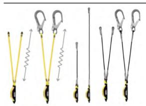
Elementos de amarre anticaidas, este equipo ya viene integrado con un absorbedor de energía, usados en situaciones con riesgo de caída, estos absorbedores funcionan por desgarro.
