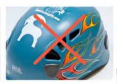
Sólo se autorizan los marcados en los elementos de confort y no sobre los elementos de seguridad. Utiliza una cinta adhesiva o una etiqueta. ¡No utilices pintura!
