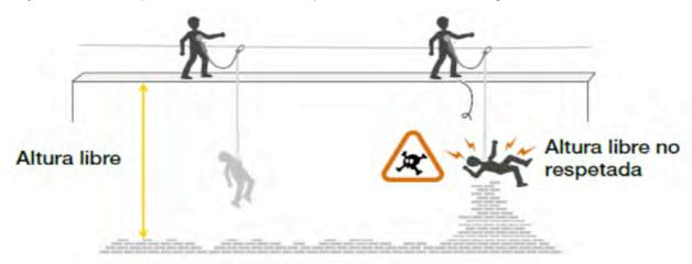
El factor de caída es el que determina la dureza o gravedad de una caída y este dice que: **A MAYOR VALOR, MAYOR GRAVEDAD**. Su valor, que en condiciones normales estará comprendido entre 0 y 2, se calcula dividiendo la altura de la caída entre la longitud de cuerda o sistema amarre utilizada para su amortiguación.
