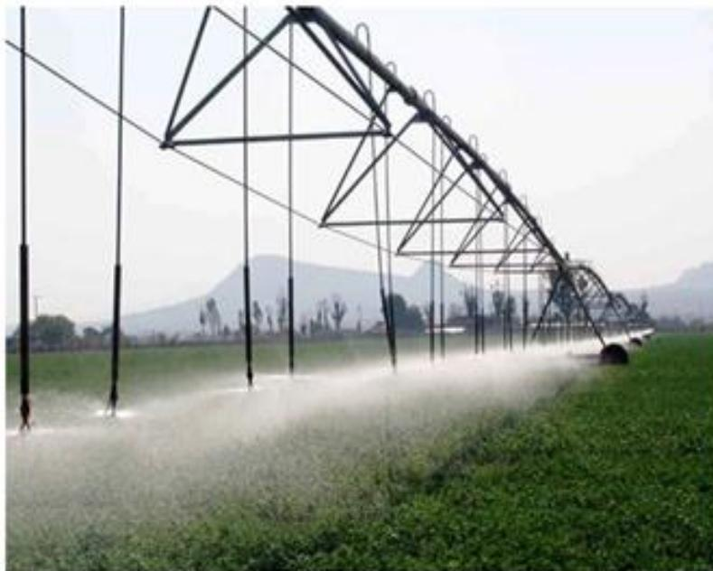
**Figura 2-19. Sistema de riego con traslación recta**
