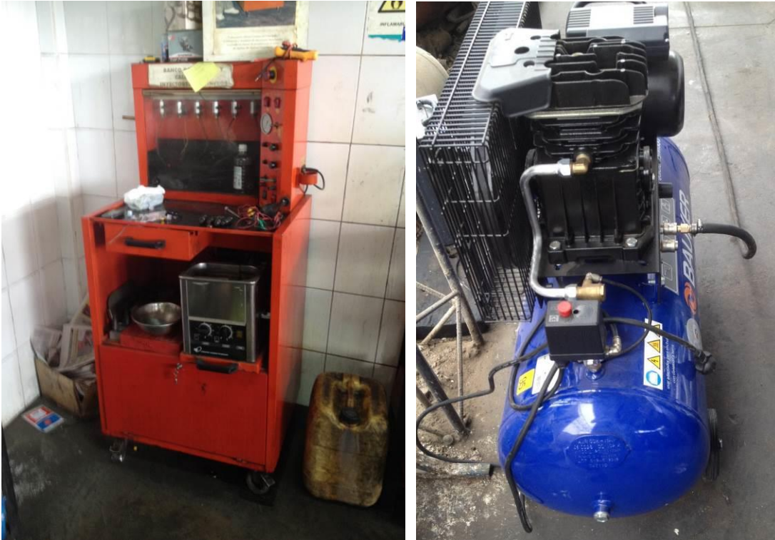
Ilustración 2: (Izq.) Banco de Limpieza de Inyectores con Ultrasonido; (Der.) Compresor de Aire Comprimido.
