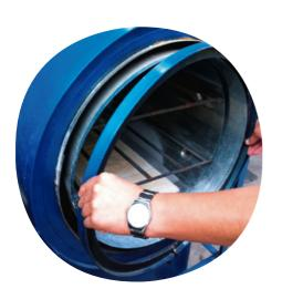
b. Retire la junta desmontable completamente.
