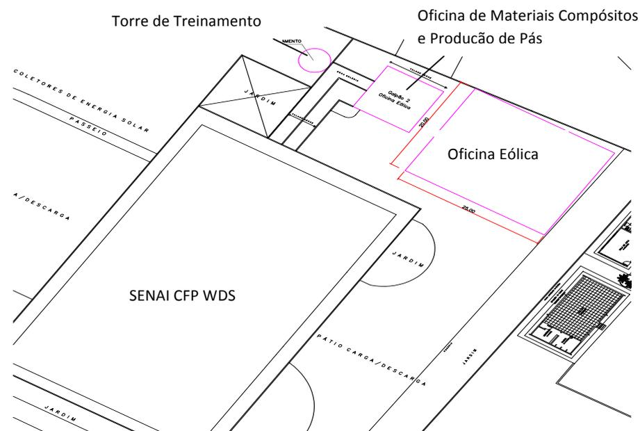
Imagem 3: Planta baixa da Ampliação da Unidade com o Centro de Treinamento Eólico
