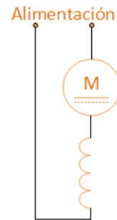
Figura 24 Esquema motor a excitación en serie
