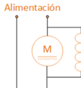
Figura 20 esquema Motor a excitación paralela
